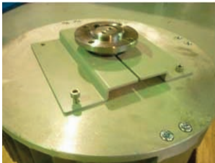
VITE M8x25 TCEI INOX (già presente sul motore) ROND. GROWER D.8 (già presente sul motore)
